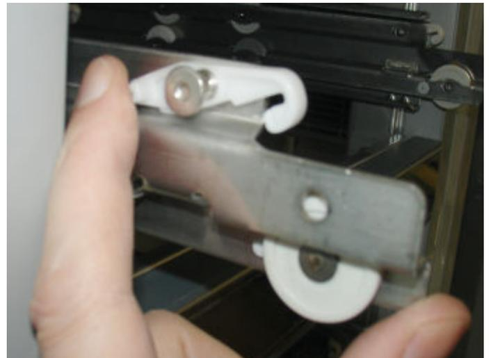
18. Die Klammern müssen nach oben geöffnet sein wie auf dem Bild
